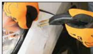
PERMETTE DI RIPARARE VELOCEMENTE CREPE E ROTTURE DI PARTI IN PLASTICA
